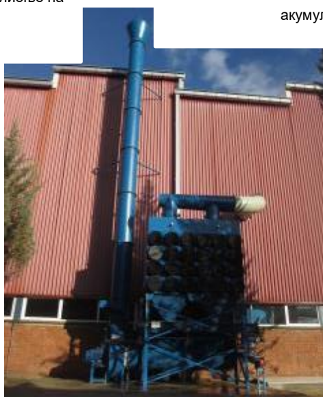
Слика 3: Филтер за прашина Downflo Donaldson во одделение за производство на плочи
